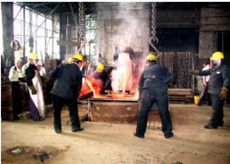
*Am 22. Juli 2005 wurde nun die letzte und schwerste Glocke gegossen. Sie wiegt 637 kg und hat einen Durchmesser von 1025 mm. Aus zwei Kübeln fließt die flüssige Bronze in die gefertigte Form, wobei keine Temperaturabweichung zwischen den beiden Kübeln bestehen darf. Die gegossene Glocke mit der Inschrift „Liebe“ muss nun abkühlen, bevor sie weiter bearbeitet wird.*
