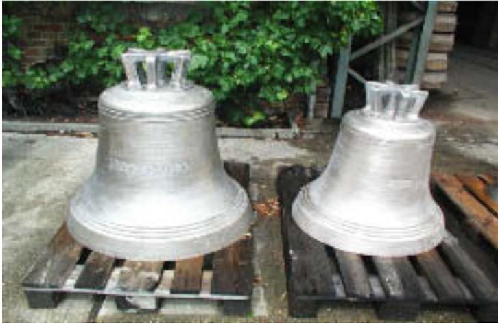
*Die Inschriften der drei Glocken lauten: „Glaube“, „Liebe“ und „Hoffnung“. Auf der Rückseite jeder Glocke steht: „Langstadt A.D. 2005“. Die kleine Glocke (225 kg schwer und 711 mm im Durchmesser) und die mittlere Glocke, so sieht man auf dem Bild links, sind bereits fertig und stehen zur Abholung in der Kunstgießerei Lauchhammer bereit.*
